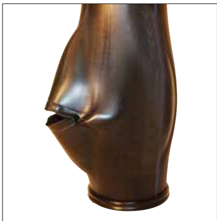
Rupture ductile, bec de perroquet
